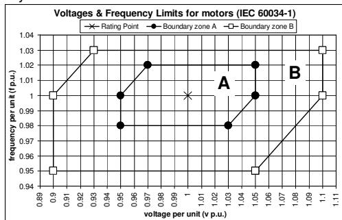
**5.3** Per il motore alimentato a tensione e frequenza **nominali** sono garantite le seguenti **copie di sovraccarico occasionali**. La temperatura dell'olio non deve **mai superare i 70 °C**! Se necessario raffreddare l'olio (punto 3.3).
